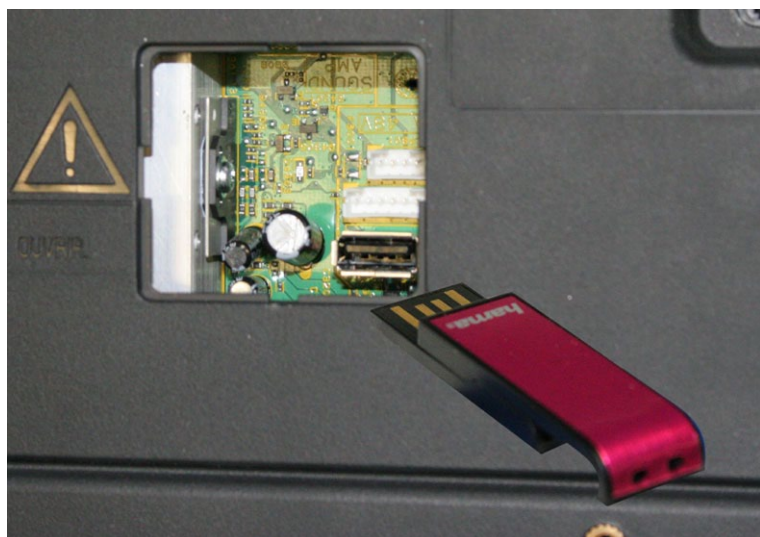
Bild 5: USB-Stick (schlanke Bauform) direkt in den USB-An- schluss einführen. Kein Verlängerungskabel verwenden.
