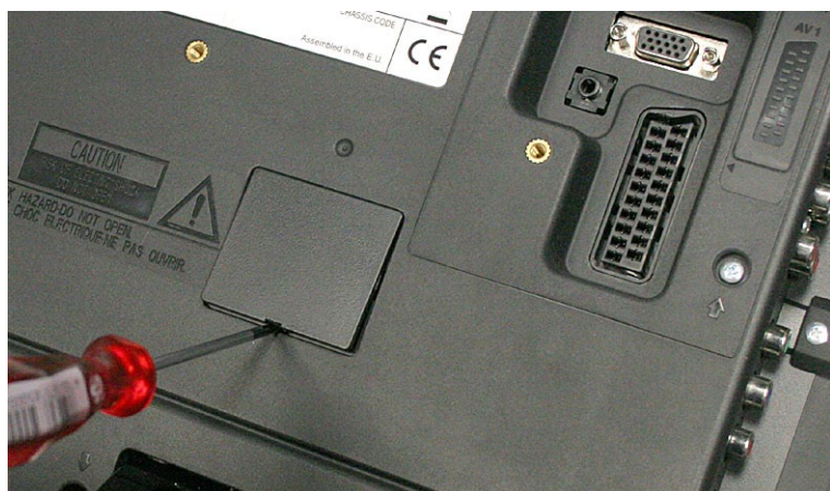
Bild 4: TV-Gerät von der Stromversorgung trennen. Service- deckel mit spitzem Gegenstand, z.B. Schraubendreher, vorsichtig anheben und entfernen.
